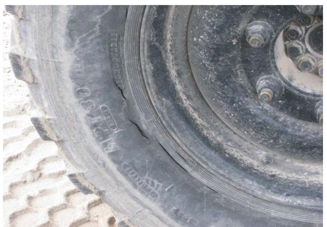
⑥タイヤ亀裂
