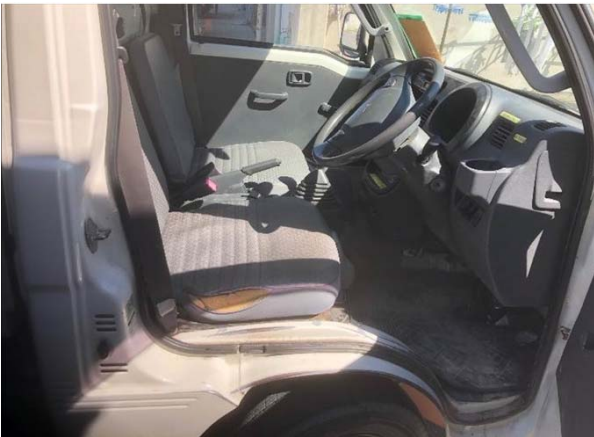
○キャビン内部 シートめくれ
