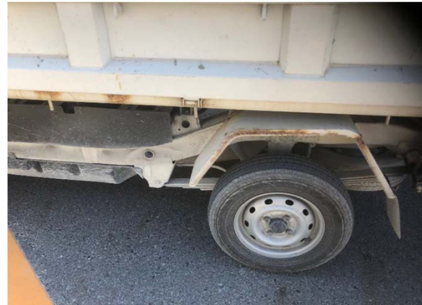
○右後ろフェンダー 腐食著しい
