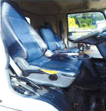
○キャビン内部 シートめくれ
