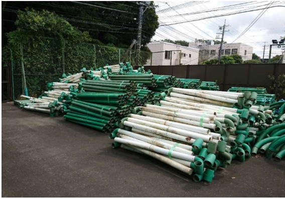
①現在の保管状況です。緑色のものが笠木、白色の端部に緑色の部材がついているものが支柱です。
