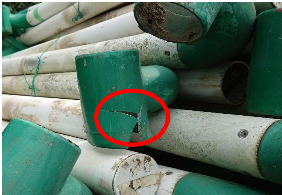
③支柱は笠木を受ける部分が破損したものが、数十本に一本程度の割合で混入しています。現地にて仕分け作業が必要になります。
